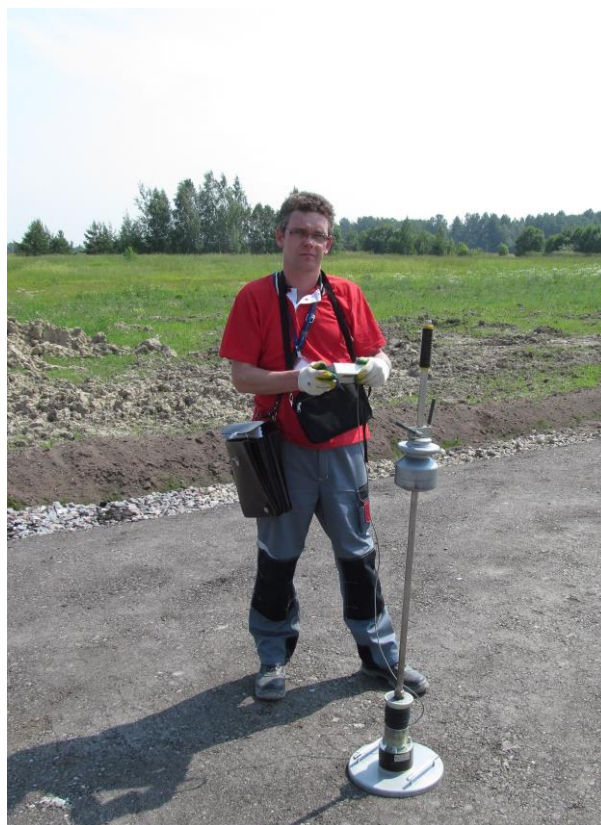
Определение степени уплотнения основания прибором ПДУ-МГ4 «Удар».
