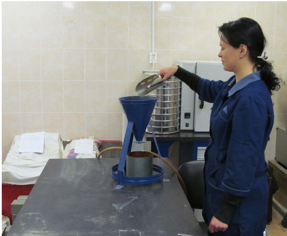
Определение насыпной плотности мелкого заполнителя испытанием прибором «Воронка ЛОВ»
