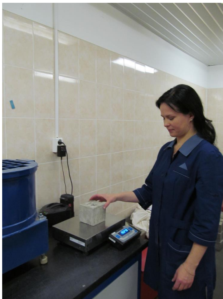
Определение массы образца кубика 10x10x10 см из товарного бетона для определения средней плотности бетона
