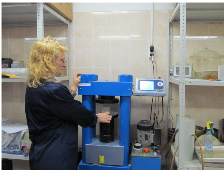
Определение прочности бетона на сжатие по образцам размером 10x10x10 см прямым разрушающим методом на прессе ИП500
